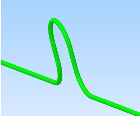
Der Nord-Süd-Draht kann mittels Dehnungs-Schleife bei der thermischen Trennlinie einfach durchgezogen werden.
